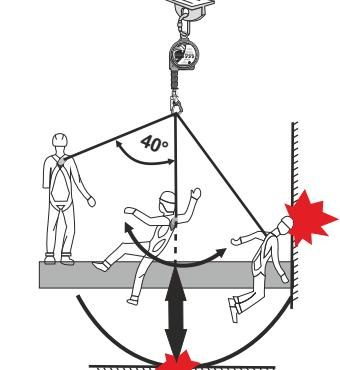
Рис. 9. Использование на горизонтальных и наклонных поверхностях
